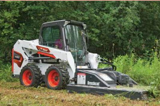
Brushcat™-Rotationsmäher: Serienmäßig mit 7-cm-Mähmesser mit Versatz und Vorderrädern. Schnitthöhe: 7,6 cm.
