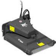
Brushcat™-Rotationsmäher: Serienmäßig mit 7-cm-Mähmesser mit Versatz und Vorderrädern. Schnitthöhe: 7,6 cm.
