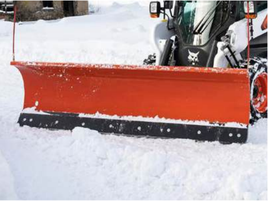
Schneeräumschild: Mit hydraulischer Abwinkelung. Maschine muss mit Frontzusatzhydraulik ausgestattet sein.
