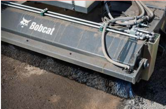
Kehrschaufel: Maschine muss mit Frontzusatzhydraulik ausgestattet sein.
