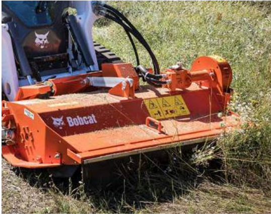
Schlegelmäher: Maschine muss mit Frontzusatzhydraulik ausgestattet sein.
