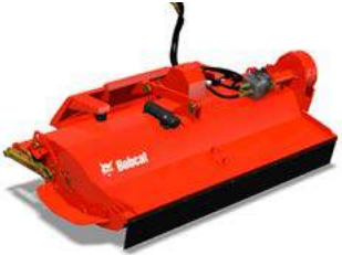
Schlegelmäher: Maschine muss mit Frontzusatzhydraulik ausgestattet sein.
