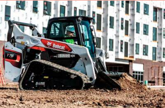
Niedrigprofilschaufeln: Mit vorgefertigten Bohrungen zum Befestigen der aufschraubbaren Schneidkante oder Zähne.
