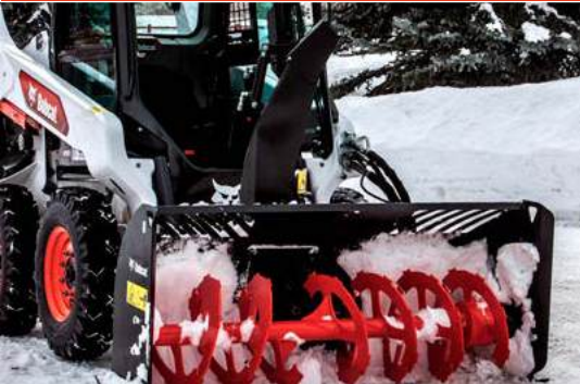
Schneefräse: Mit Hydraulikmotorpaket. Der Lader muss mit einem 7-poligen Elektrosteuersatz ausgestattet sein.
