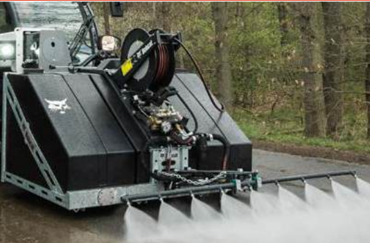
Hochdruckreiniger: Lader muss mit einem Elektrosteuersatz ausgestattet sein.
