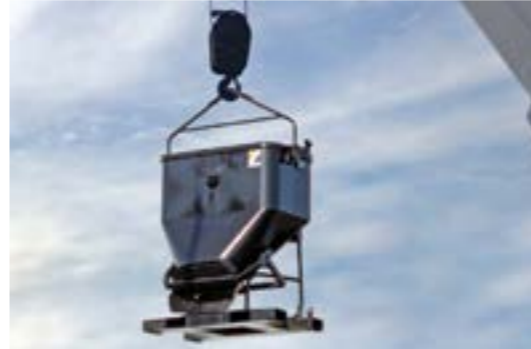
Betonkübel: Die Verwendung von Gabeln ist zwingend erforderlich.
