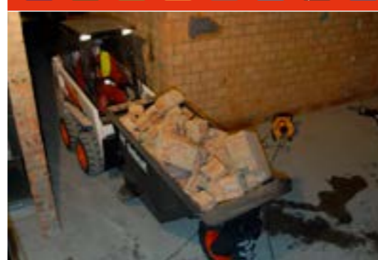
Anbaudumper: Mit 8,5 x 12 Bobcat-Hochleistungsreifen (Heavy Duty). Reifen müssen am Anbaudumper montiert werden.
