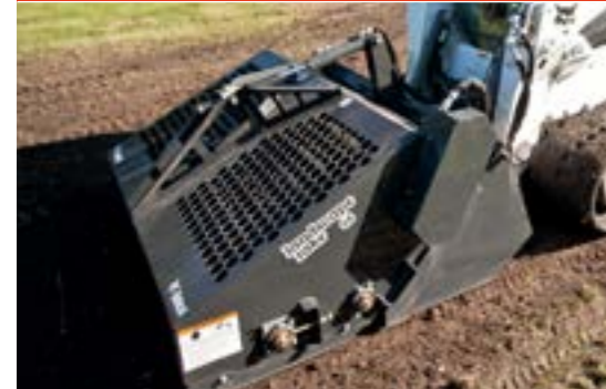
Steinsammelschaufel: Maschine muss mit Frontzusatzhydraulik ausgestattet sein.
