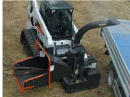
Holzshredder: Der Lader muss mit einem 7-poligen Elektrosteuersatz ausgestattet sein.
