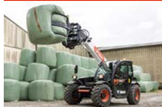
Ballengreifer mit Zinken: Maschine muss mit Frontzusatzhydraulik ausgestattet sein.
