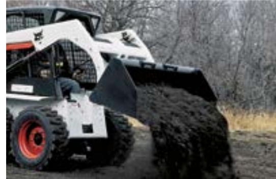
Dünger- und Getreideschaufeln: Mit vorgefertigten Bohrungen zum Befestigen von aufschraubbaren Schneidkanten.
