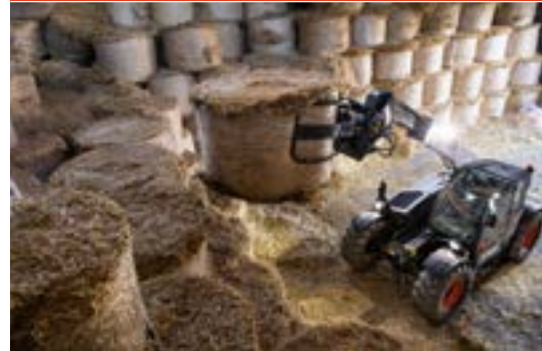
Ballenklammer: Maschine muss mit Frontzusatzhydraulik ausgestattet sein.
