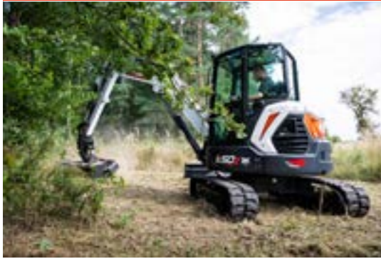
SL-Schlegelmäher: Der Träger muss über eine geschlossene Kabine verfügen.
