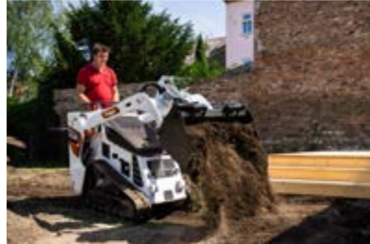
Universalschaufeln (GP): Mit vorgefertigten Bohrungen zum Befestigen der aufschraubbaren Schneidkante oder Zähne.
