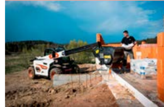
Mischschaufel: Maschine muss mit Frontzusatzhydraulik ausgestattet sein.
