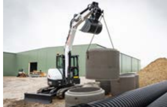
Löffel: Die Maschine muss mit dem Kupplungssystem QC03 nach deutscher Bauart ausgerüstet sein.
