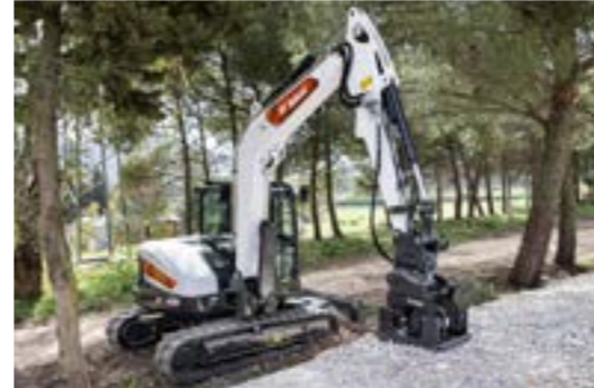
Plattenverdichter: Benötigt Schlauchsatz + Kopfplatte + Plattenverdichter
