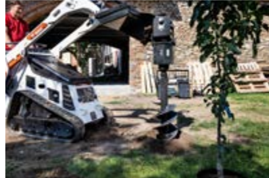
Erdbohrer: Benötigt Anbaurahmen + Antriebseinheit + Schnecke
