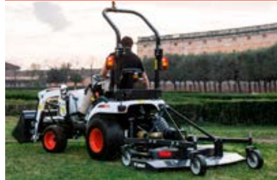
Anforderungen: Heckzapfwelle mit 540 U/min
