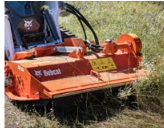
Schlegelmäher: Maschine muss mit Frontzusatzhydraulik ausgestattet sein.
