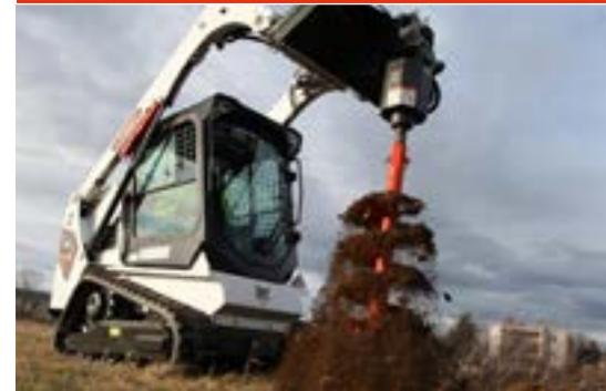
Erdbohrer: Kopfplatte + Antriebseinheit + Schnecken + Sonderausstattung erforderlich.
