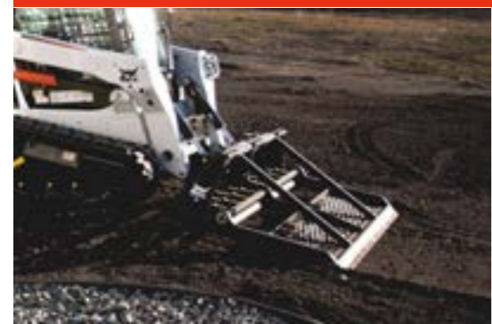
Nivellierrechen: Mit verlängertem Metallsieb, Aufreißer, Zähnen und dazugehörigen Befestigungskomponenten.
