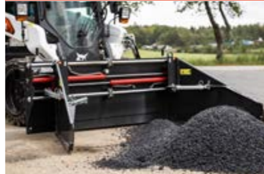
Straßenfertiger: Lader muss mit einem Elektrosteuersatz ausgestattet sein.
