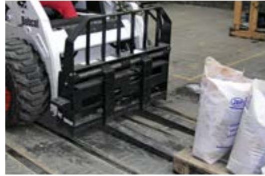
Palettengabel, hydraulisch: Mit Rückwandrahmen und 2 hydraulisch verstellbaren Zinken.
