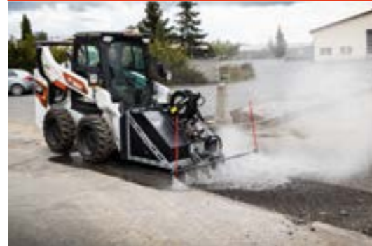
Hochdruckreiniger: Der Lader muss mit einem Elektrosteuersatz ausgestattet sein (außer bei Modell KC19-250S).
