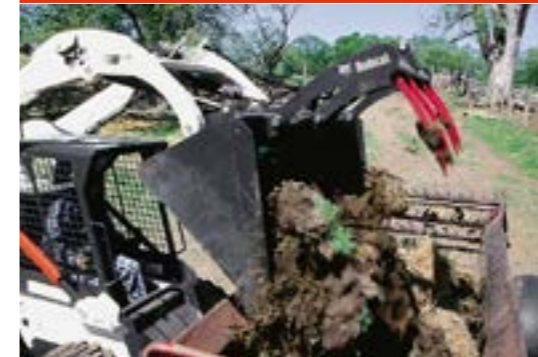
Universal-/Agrargreifer: Zur Montage an der Schaufel.
