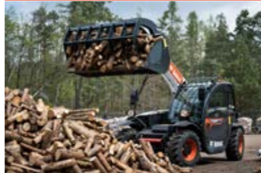
Schaufelgreifer: Maschine muss mit Frontzusatzhydraulik ausgestattet sein.
