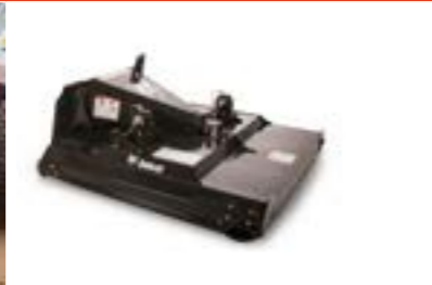
Brushcat™-Rotationsmäher: Serienmäßig mit 7-cm-Mähmesser mit Versatz und Vorderrädern. Schnitthöhe: 7,6 cm. Maschine muss mit Frontzusatzhydraulik ausgestattet sein.
