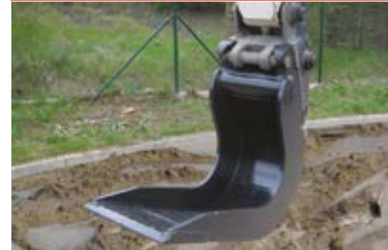
Lehmlöffel: Armaturen in Abhängigkeit vom genutzten Kupplungssystem.
