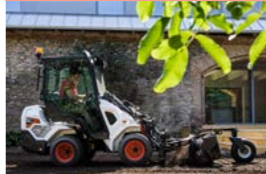
Kraftrechen: Lader muss mit einem Elektrosteuersatz ausgestattet sein.
