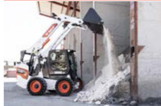
Bau-/Industrieschaufeln (CI): Mit vorgefertigten Bohrungen zum Befestigen der aufschraubbaren Schneidkante oder Zähne.
