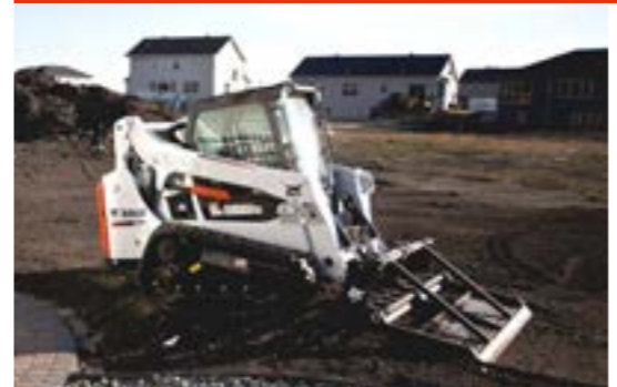
Nivellierrechen: Mit verlängertem Metallsieb, Aufreißer, Zähnen und dazugehörigen Befestigungskomponenten.
