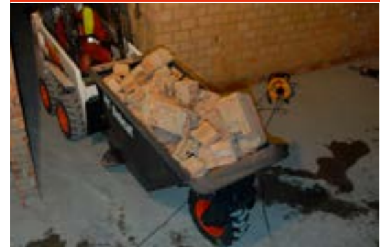
Anbaudumper: Mit 8,5 x 12 Bobcat-Hochleistungsreifen (Heavy Duty). Reifen müssen am Anbaudumper montiert werden.
