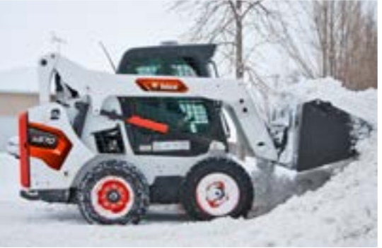
Schnee- und Leichtgutschaufel: Mit vorgefertigten Bohrungen zum Befestigen von aufschraubbaren Schneidkanten.
