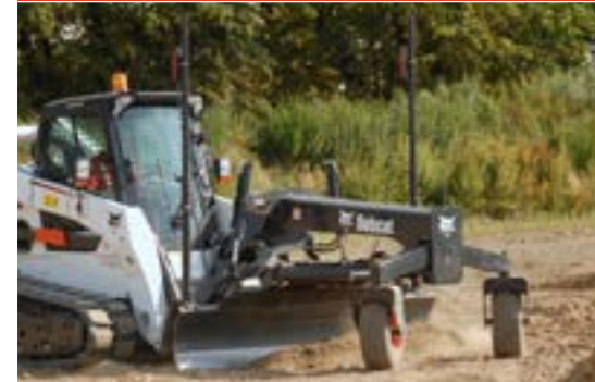
Anbaugrader: Lader muss mit einem Elektrosteuersatz ausgestattet sein.
