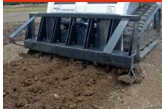
Aufreißer: Mit 2 höhenverstellbaren Kufen und 5 Zinken.
