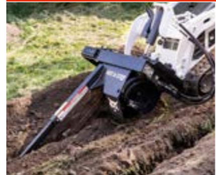
Anforderungen: Maschine muss mit Frontzusatzhydraulik ausgestattet sein.
