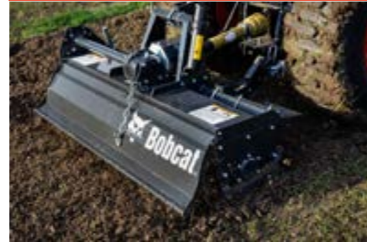
Bodenfräse: Heckzapfwelle mit 540 U/min.
