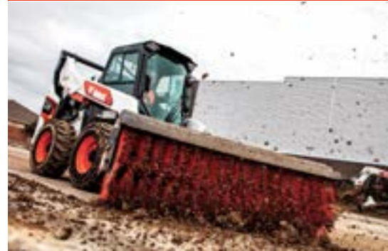
Schwenkbesen: Lader muss mit einem Elektrosteuersatz ausgestattet sein.
